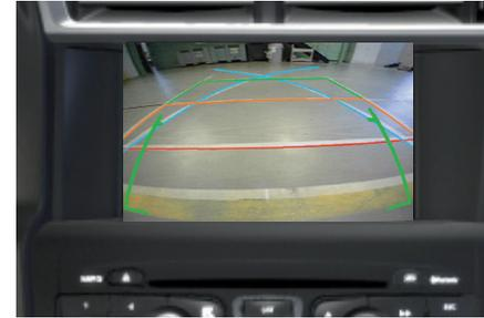
Os traços vermelhos representam cerca de 30 cm após o limite do para-choques traseiro do seu veículo. O sinal sonoro torna-se contínuo a partir deste limite. Os traços azuis representam o raio de giro máximo.
