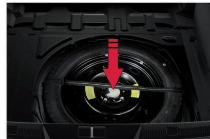
**!** Quando o veículo está equipado com uma roda reserva de tamanho diferente, é obrigatório não ultrapassar a velocidade de 80 km/h com esta roda reserva. Os parafusos das rodas são específicos para cada tipo de roda. Em caso de troca das rodas originais, verificar com a Rede de concessionárias CITROËN ou em uma oficina qualificada, da compatibilidade dos parafusos com as novas rodas.
