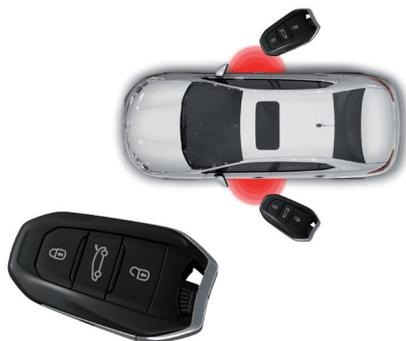
Sistema que permite a abertura, o fechamento e o partida do veículo mantendo a chave eletrônica consigo.
