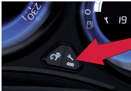
Com o motor em funcionamento, para iniciar um teste manual pressione brevemente o botão ".../000" no painel de instrumentos.
