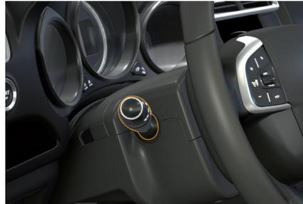
Manutenção temporária da iluminação das faróis baixos, após desligar a ignição do veículo, que facilita a saída do condutor em caso de fraca luminosidade.
