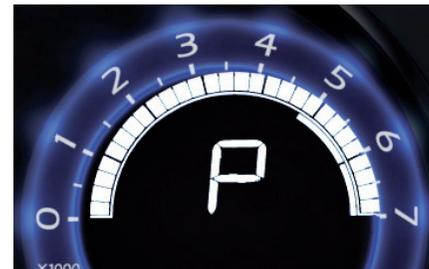
Quando deslocar a alavanca na grelha para selecionar uma posição, acende o respectivo indicador no visor do painel de instrumentos.
