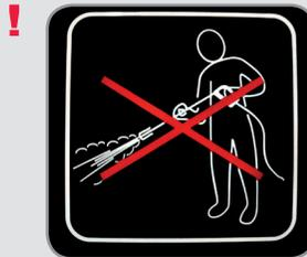
Para não danificar os componentes elétricos do veículo, é expressamente **proibido** utilizar a lavagem a alta pressão no compartimento do motor.
