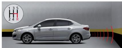
A colocação em funcionamento é obtida através da engrenagem da marcha a ré, sendo acompanhada de um sinal sonoro. A função é desativada quando se desengrena a marcha a ré.
