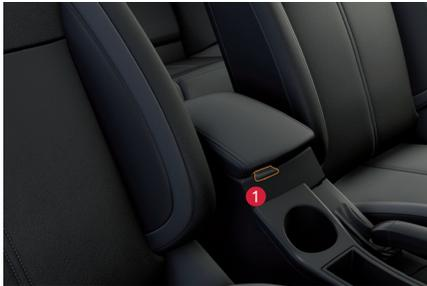
☞ Para o avançar, puxe o comando 1 e suspenda o apoio de braços. O apoio de braços desliza até ao batente para a frente.
