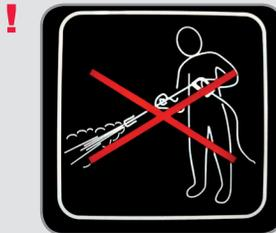
Para não danificar os componentes elétricos do veículo, é expressamente **proibido** utilizar a lavagem a alta pressão no compartimento do motor.
