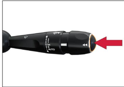
Tecla, na extremidade do comando do limpavidros: pressione para visualizar sucessivamente os diferentes dados do computador de bordo.
