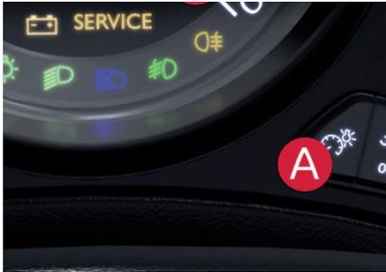
Permite regular manualmente a intensidade luminosa do posto de condução em função da luminosidade exterior. Funciona apenas quando as luzes se encontrarem acesas, em modo noturno.
