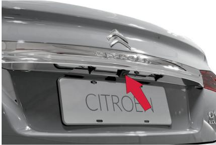
Uma câmara de marcha a ré é ativada automaticamente ao engrenar a marcha a ré. O retorno visual a cores é efetuado na tela de navegação.
