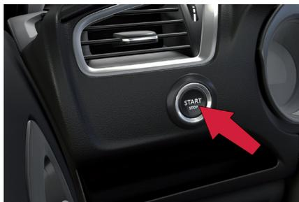
**i** Se uma das condições de partida não for aplicada, é visualizada uma mensagem no painel de instrumentos. Em certos casos, é necessário virar o volante pressionando o botão "START/STOP" para ajudar ao desbloqueio da coluna de direção, é avisado por uma mensagem.
