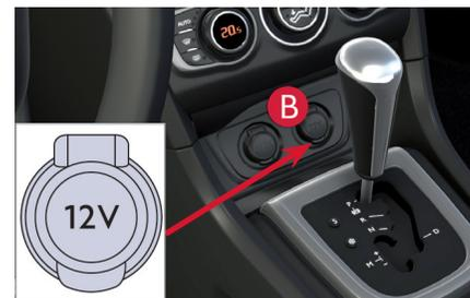
☞ Para ligar um acessório de 12 V (potência máxima: 120 W), ligue o adaptador adequado na tomada 12V.
