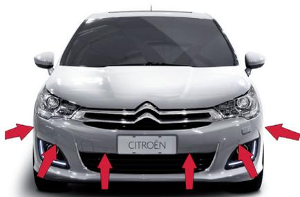
**i** O som difundido pelo altifalante (dianteiro ou traseiro) permite determinar se o obstáculo se encontra na dianteira ou na traseira.
