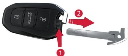
A chave integrada serve para travar ou destravar o veículo quando a chave eletrônica não funciona:
