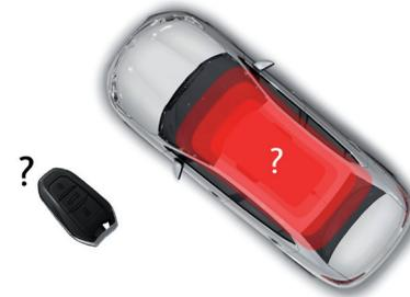
Se a chave eletrônica não se encontrar na zona definida quando o veículo se encontrar em movimento ou quando solicitar a parada do motor (posteriormente), aparece uma mensagem no painel de instrumentos.
