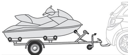
Dispositivo mecânico adaptado ao engate de um reboque com uma sinalização e iluminação complementares.
