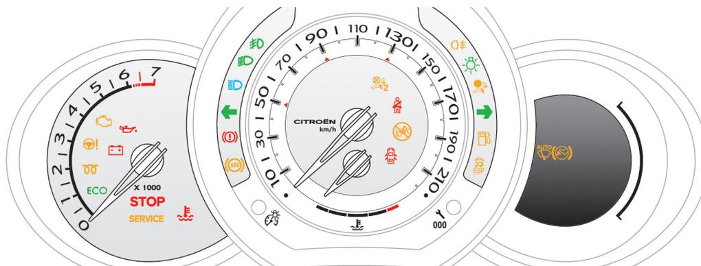
Referências visuais que informam o condutor relativamente ao funcionamento de um sistema (luzes indicadoras de marcha ou de neutralização) ou ao aparecimento de uma anomalia (luz indicadora de alerta).
