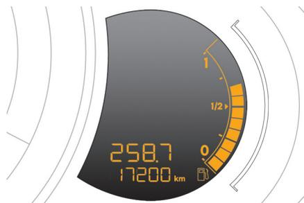
Sistema que informa o condutor sobre o prazo para a próxima revisão a efetuar, de acordo com o plano de manutenção. Este prazo é calculado a partir da última reposição a zeros do indicador. Ela é determinada por dois parâmetros:
