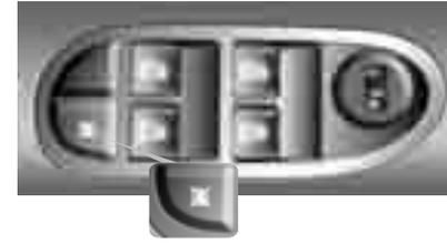
Para evitar que los ocupantes del vehículo operen las ventanas a su antojo, existe un interruptor de bloqueo central que está ubicado en el descansa brazos de la puerta del conductor. Al presionar el botón de bloqueo, los pasajeros no podrán operar las ventanas. El conductor puede operar todas las ventanas aún cuando estén bloqueadas. Las ventanas se desbloquearán si el botón de bloqueo se presiona nuevamente.
