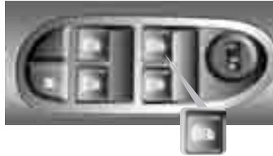
El interruptor de las ventanas eléctricas, ubicadas al lado del asiento del conductor, cuenta con la función de bajar rápidamente las ventanas. Presione el interruptor hasta el fondo y luego suéltelo. La ventana se abrirá completamente. Para detener la apertura de la ventana, presione nuevamente el interruptor. Si mantiene el interruptor tirado hacia arriba, la ventana se elevará hasta cerrarse.
