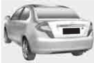
Para abrir la cubierta del maletero, inserte la llave y gírela hacia la derecha, esto hará que la cubierta se levante. Para cerrar la tapa del maletero, presione hacia abajo la cubierta con fuerza y quedará cerrada.
