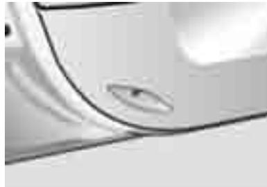
Al abrir la puerta delantera o trasera, la luz interna de control se encenderá. La luz de control de la puerta se encuentra en la parte interior de la puerta del conductor y del copiloto, y en las puertas de los pasajeros traseros. Al cerrar la puerta, esta luz se apagará.
