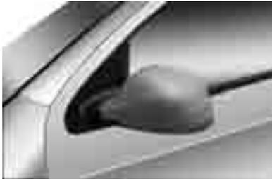
Empuje el espejo retrovisor exterior hacia la parte trasera del vehículo, girándolo hacia el costado del vehículo.
