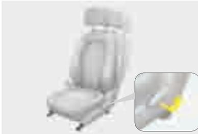
Su vehículo está equipado con una palanca manual de ajuste ubicada en la parte externa del asiento, la que le permite ajustar la inclinación del respaldo del asiento.
