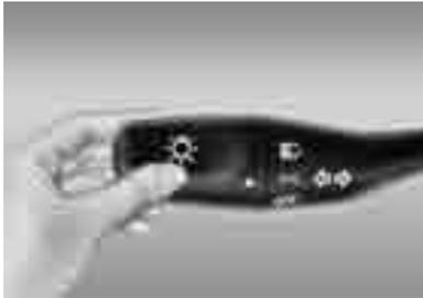
El funcionamiento de los intermitentes (señal de viraje y cambio de carril) tiene dos posiciones hacia arriba (giro a la derecha) y dos hacia abajo (giro a la izquierda). Estas posiciones se usan para diferenciar la señal de viraje de la de cambio de carril.
