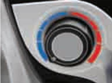
Control de la temperatura: Gire el interruptor en la dirección azul (izquierda) para reducir la temperatura; gire el interruptor en la dirección roja (derecha) para elevar la temperatura. Empleando este interruptor usted puede lograr condiciones perfectas de enfriamiento o calefacción.
