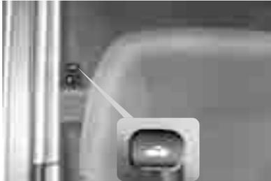
Para abrir el maletero, tire hacia arriba la palanca que está ubicada en extremo inferior izquierdo del asiento del conductor.
