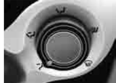
Este interruptor se emplea para controlar la dirección del flujo de aire. Puede direccionar el flujo de aire hacia el piso (pies), hacia las aberturas de salida o hacia el parabrisas. Los 5 signos indican posiciones hacia la cara, pies y cara, pies y cara, pies y cara, pies y cara, y sólo desempañado del parabrisas.
