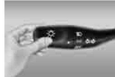
Opere las luces de estacionamiento, luces bajas y luces traseras girando el interruptor (tipo barril) que está al extremo del comando multipropósito. Los indicadores de las luces se encenderán en el panel de control combinado cuando el interruptor se ubique en la primera posición y, las luces en sí, se encenderán cuando se ubique en la segunda posición.
