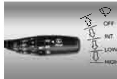
Opera el limpia parabrisas delantero empleando el telecomando ubicado al lado derecho del volante. Sólo puede hacerse funcionar estando la llave de encendido en ON.
