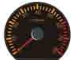
El tacómetro indica las revoluciones por minuto del motor (rpm). Para aumentar la eficiencia económica de combustible, mantenga la velocidad del motor entre 2.000 y 3.000 rpm. durante la conducción. Nunca exija el motor hasta la zona roja del tacómetro.
