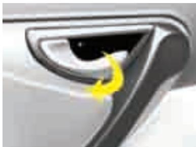
Con el botón del seguro de la puerta abierto (desbloqueado), tire de la manilla de la puerta hacia adentro y la puerta se abrirá. Para abrir la puerta desde afuera, tire de la manilla de la puerta hacia afuera.
