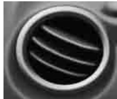
Mueva las hojas de la salida de aire para cambiar la dirección y cantidad del flujo de aire.
