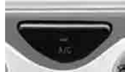
Interruptor del A/C: presione el botón del A/C y el sistema de A/C se iniciará o detendrá.
