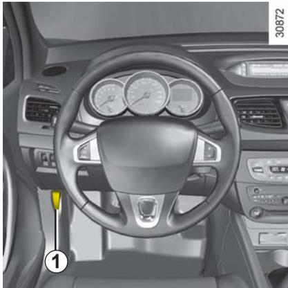
Para abrir, puxe a alavanca **1**, situada do lado esquerdo do painel de instrumentos.
