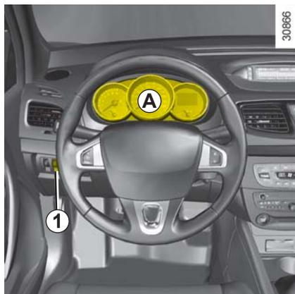
**Painel de instrumentos A:** Acende quando o veículo é ligado. É possível regular a intensidade luminosa girando o botão **1**.
